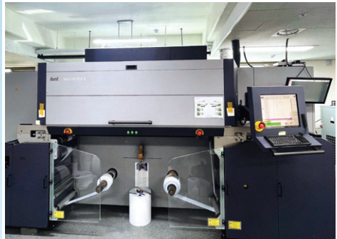
더스트 RSC E 8도 디지털 인쇄기 Durst RSC E 8 colors Digital Printing Machine
